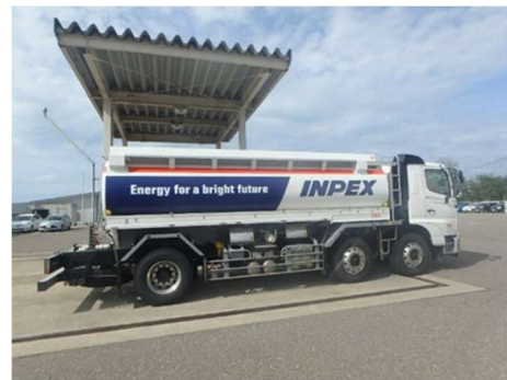
RD40 を給油した INPEX ロジスティクス タンクローリー車
